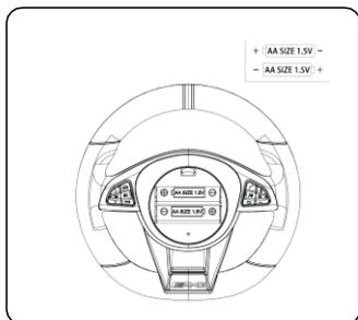
8. Відкрийте відсік для батарейок. Встановіть дві батарейки типу АА, дотримуючись полярності. Закрийте кришку і закріпіть гвинтами.
