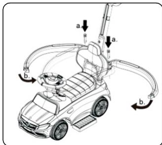
6. Встановіть бортики безпеки, закріпивши спочатку їх за спинкою за допомогою засувки, а потім вставте бортики в отвір фіксатора.
