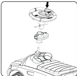
2. Вставте верхню частину поворотного важеля в фікатор для бортика безпеки і рульове колесо, щільно затягнувши болтом і гайкою.
