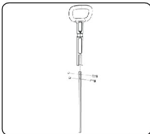
4. З'єднайте батьківську ручку з сполучною трубкою і зафіксуйте за допомогою двох болтів і гайок.
